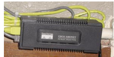
在禮堂內使用Cisco Aironet Power Injector利用Ethernet供電。
